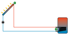
Interner Wärmetauscher, Pumpenlogik
