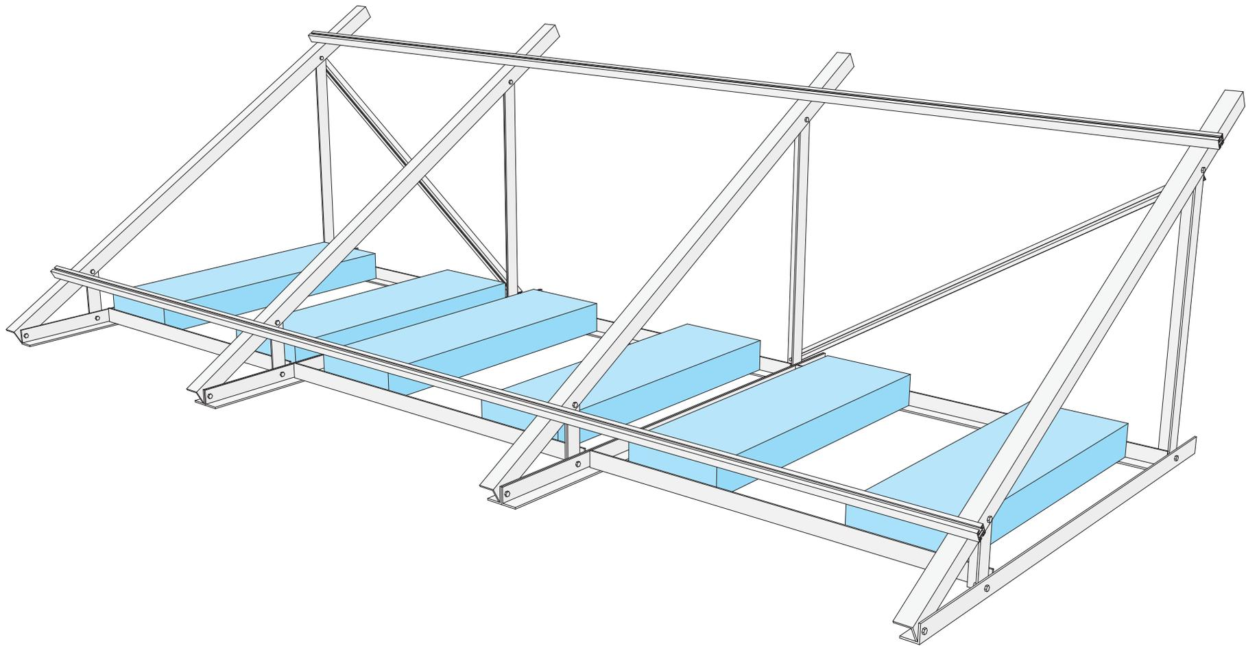
Zwischen die Aufnahmeprofile werden die Beschwerungselemente, wie beispielsweise Betonborde o.ä. eingelegt. Die Größe der Beschwerung, welche von der Windzone und Gebäudehöhe abhängt, ist der regulären Montageanleitung für die Flachdach- und Fassadenmontage zu entnehmen.
