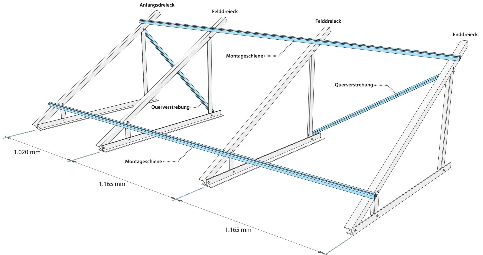
Gemäß den Abständen der regulären Montageanleitung für die Flachdach- und Fassadenmontage werden die Dreiecke positioniert und mit den Montageschienen und Querverstreibungen verbunden. Systemlinie für den Abstand ist hier beim Anfangs- und Enddreieck jeweils die Aussenkante von Teil B+ (Anfangsdreieck) und Teil B (Enddreieck). Bei den Felddreiecken wird die Mitte zwischen Teil B und B+ als Systemlinie angenommen.
