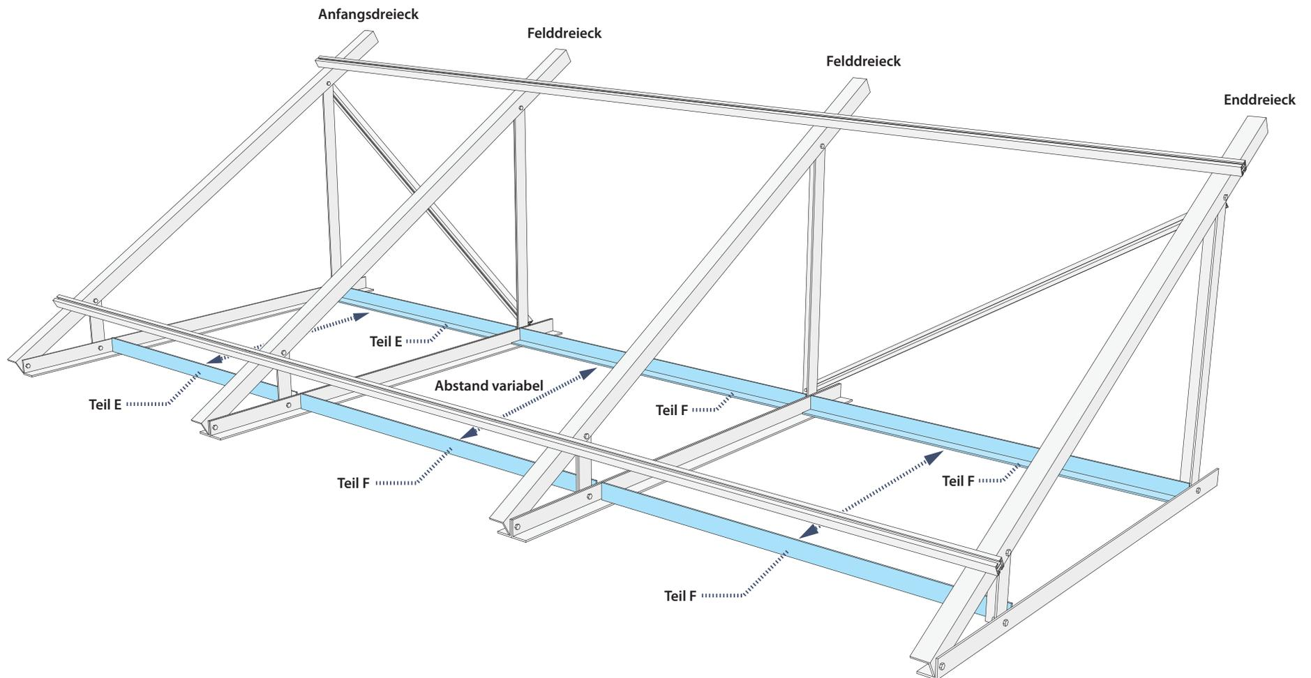
Zwischen den Dreiecken werden die Aufnahmeprofile E und F eingelegt, die für die Aufnahme von Betonborden oder ähnlichen Beschwerungselementen dienen. Aufgrund des geringeren Abstands zwischen Anfangsdreieck und Felddreieck kommen dabei in diesem ersten Abschnitt die kürzeren Aufnahmeprofile E zum Einsatz. In den anderen Abschnitten werden die Profile F verwendet. Die Distanz zwischen jeweils zwei Aufnahmeprofilen kann dabei gemäß den Dimensionen der Beschwerungselemente angepasst werden.
