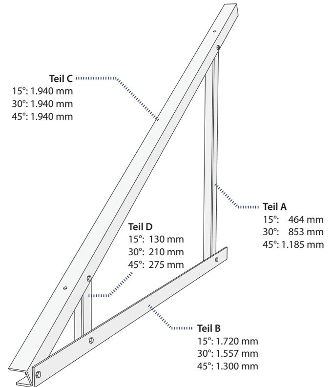
Bei Verwendung des Ballastierungsaufnahmesystems ist bei der Montage der Aufständerdreiecke zu beachten, dass diese sich in 3 Typen unterscheiden: 1x das Anfangsdreieck, je nach Feldgröße (siehe Stückliste - Punkt 6) kein, 1x oder mehrmals das Felddreieck und 1x das Enddreieck. Das Anfangsdreieck ist das Erste, das Enddreieck das Letzte des Kollektorfeldes und das/die Felddreieck(e) stehen dazwischen. Der Unterschied zwischen den 3 Typen besteht in Verwendung des Teils B und B+.
