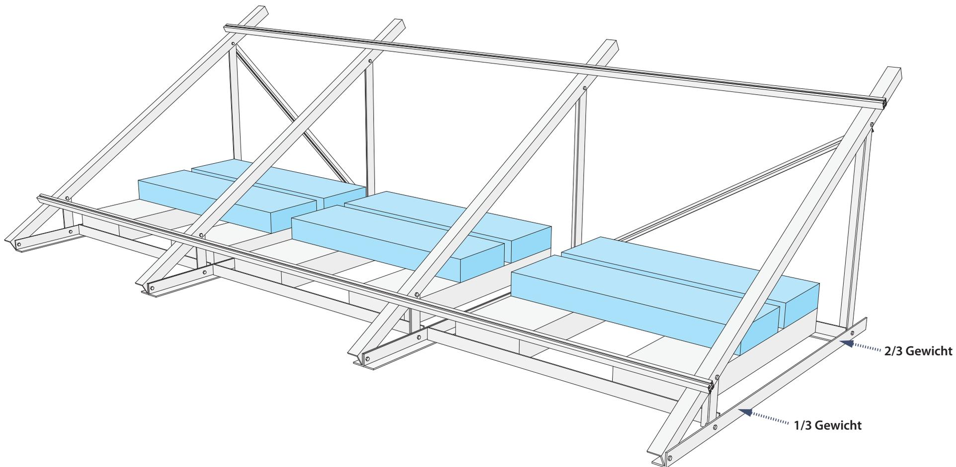
Bei der Notwendigkeit eines möglichst hohen Ballastierungsgewichtes muss eine größere Anzahl an Beschwerungselementen verwendet werden. Diese werden im Kreuzverbund aufeinandergestapelt. Bei der Verteilung der Elemente sollte  $\frac{1}{3}$  des Gewichtes im vorderen Bereich (Dreiecksspitze) und  $\frac{2}{3}$  im hinteren Bereich (Dreiecksrückseite) liegen.
